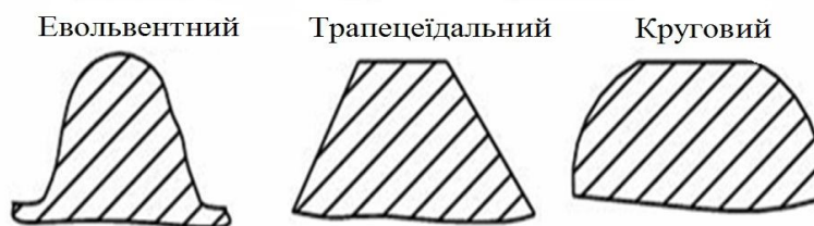
Рисунок 65 – Профілі зуба зубчастих передач
